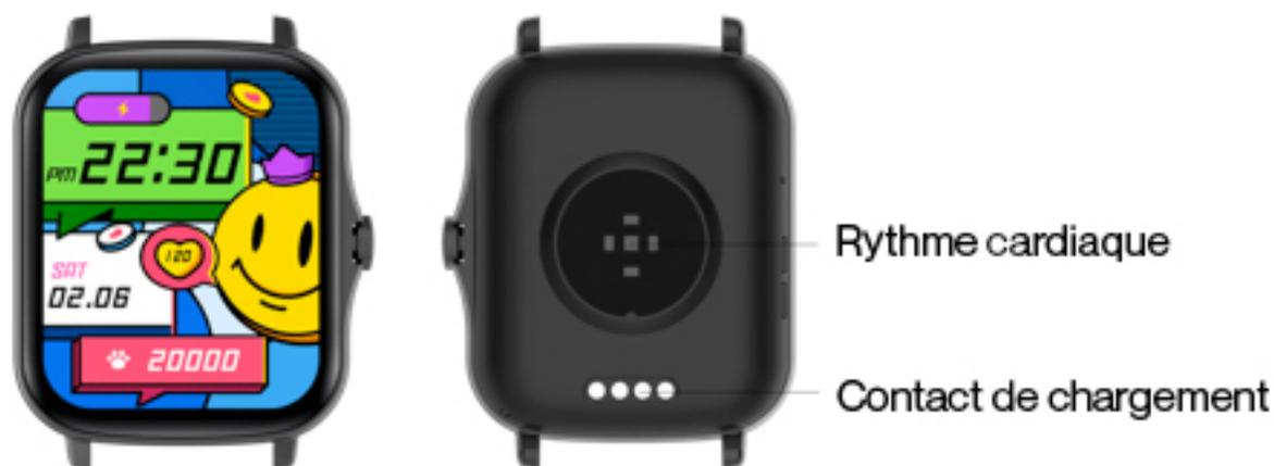
Appuyez sur le bouton latéral pendant 3 secondes ou branchez le câble de charge magnétique pour charger la montre intelligente.
